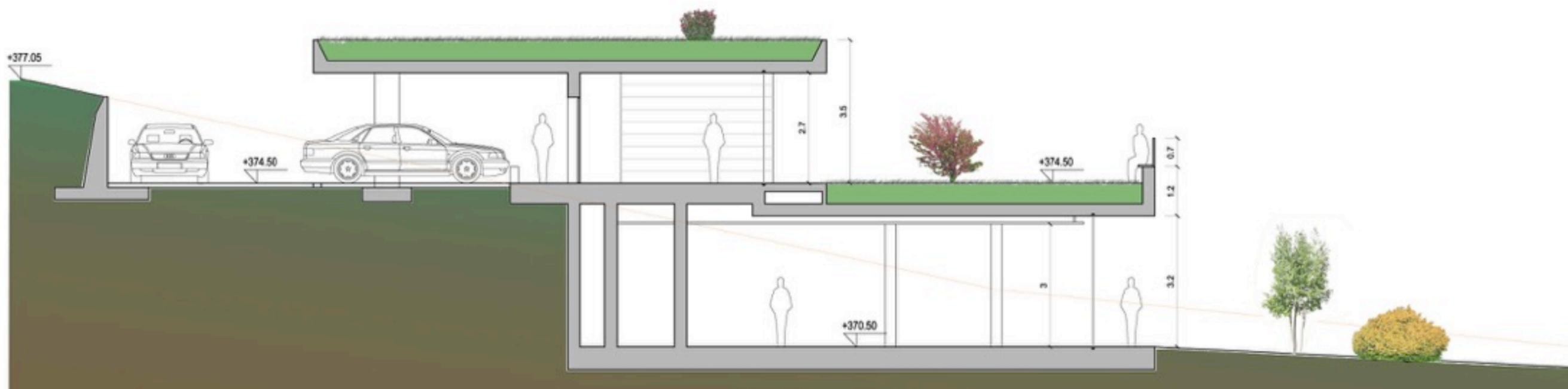
Sezione trasversale D-D' - scala 1:100
